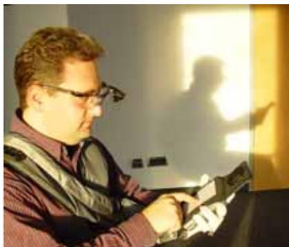
Der Datenhandschuh enthält neben der Sensorik für die Gestensteuerung einen RFID-Leser, der komplexe Eingaben durch das Scannen eines RFID-Tags ersetzt. Muss vor Ort eine Baugruppe spezifiziert werden, kann das durch einfaches „Handauflegen“ auf ein dort angebrachtes RFID-Tag erfolgen. Zusätzlich können z. B. auch mitgebrachte Werkzeuge oder Ersatzteile per RFID identifiziert werden, so dass das mobile System proaktiv vor der Verwendung eines unpassenden Werkzeuges oder Bauteiles warnen kann.
