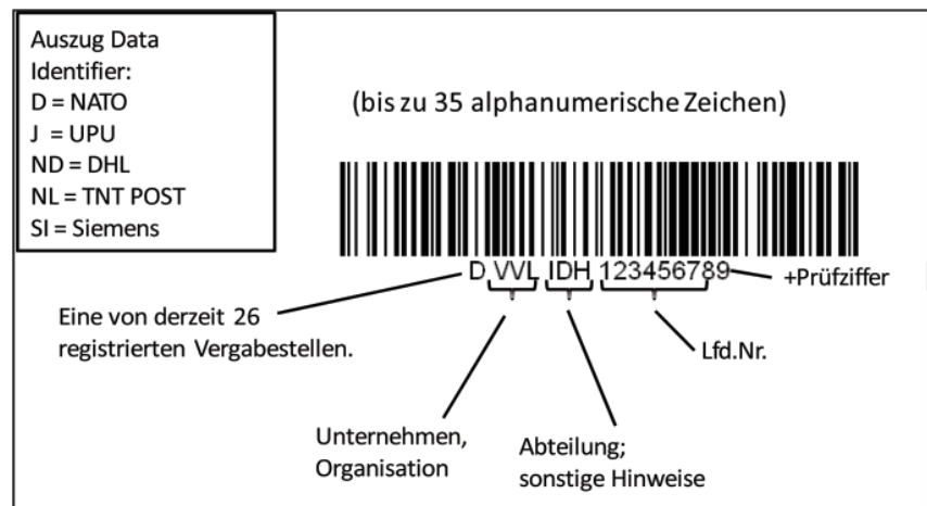
Abbildung 1: Beispiel zum Aufbau einer eindeutigen Seriennummer mit ISO/IEC 15459
