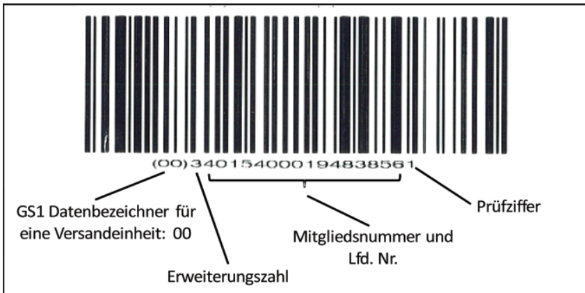
Abbildung 2: GS1 Serial Shipping Container Code einer Transportpalette
