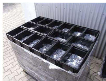
Abb. 3: Getestete Referenzpalette mit ESD-Behältern
