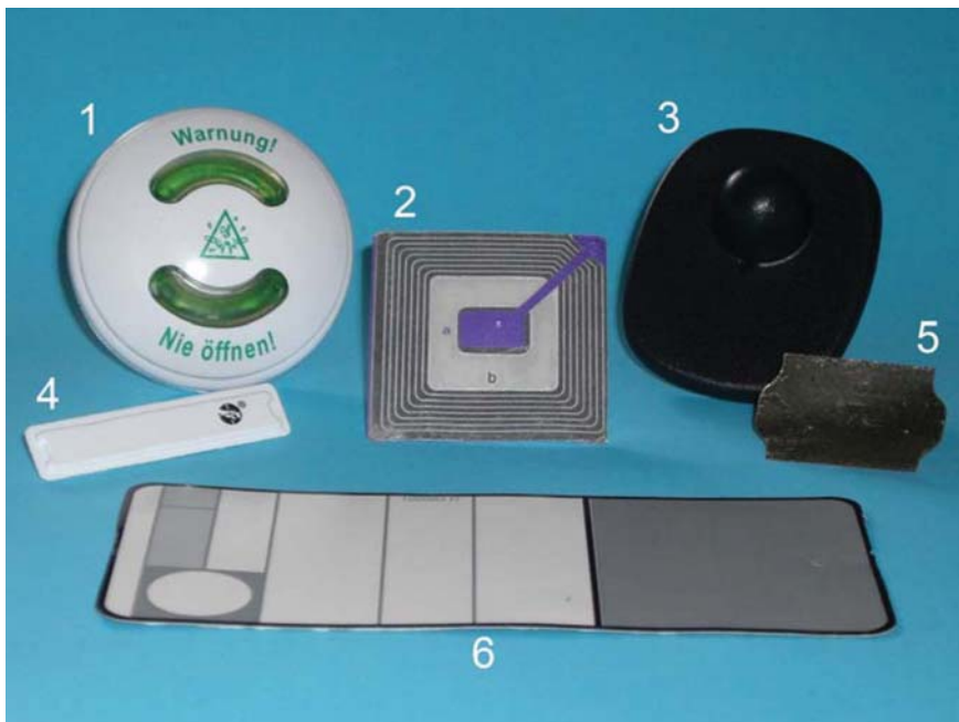
Abb. 1 Verschiedene Bauformen von EAS-Sicherungsetiketten (1. RF-Hartetikett mit Farbnadel, 2. RF-Klebeetikett, 3. RF-Hartetikett, 4. AM-Klebeetikett, 5. EM-Klebeetikett, 6. RF-Preisetikett)
