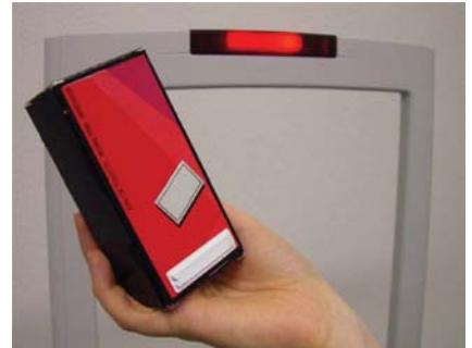
Abb. 2 Mit einem AM-Etikett gesichertes Produkt bei einem Detektionstest
