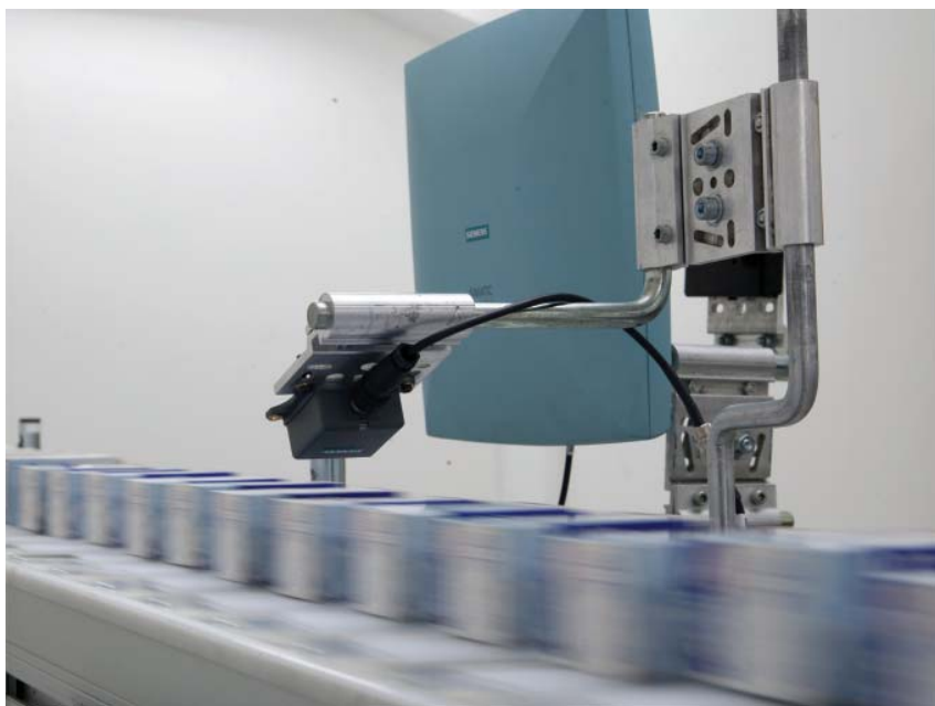
Abb. 4: Versuchsstand zur Abbildung von Einzel- und Pulkidentifikationsprozessen
