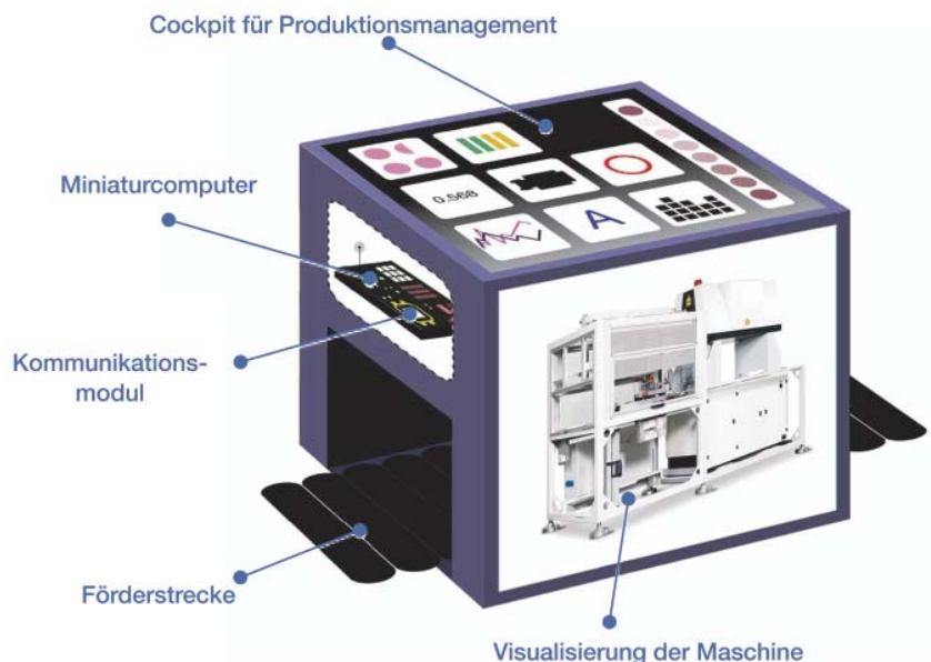
Bild 1 zeigt den prinzipiellen Aufbau eines Demonstrators. Gemäß den genannten Produktionsobjekten werden fünf Typen von Demonstratoren eingesetzt.
