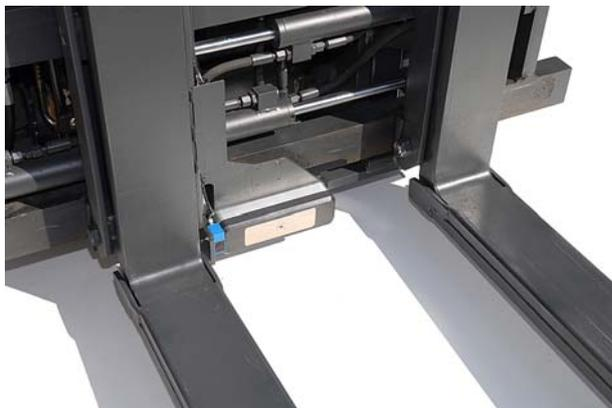
**Das mobile Gate: RX20-20 von STILL mit RFID-Antenne**
