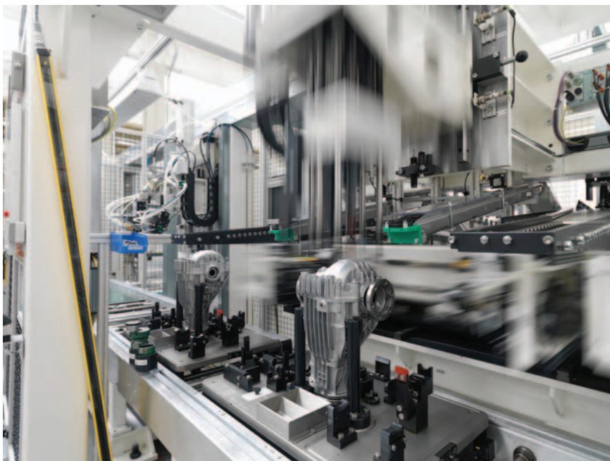
Getriebe auf Achse: Im Werk Baunatal fertigt Volkswagen bis zu 30 unterschiedliche Hinterachsgetriebetypen parallel unter Einsatz eines berührungslosen Identifizierungssystems Simatic RF300 von Siemens.
