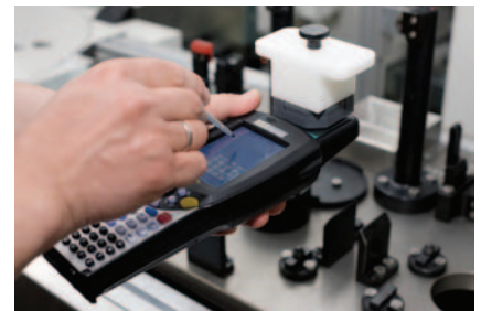
Das mobile Bedienterminal Simatic RF310M leistet wertvolle Dienste bei Inbetriebnahme und Instandhaltung.
