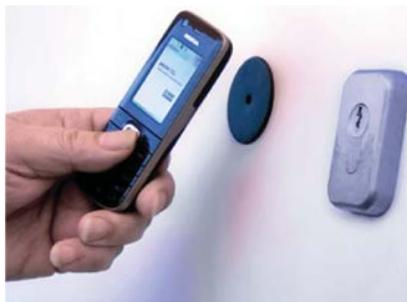
Das Personal erhält im Objekt- und Personenschutz Telefone mit RFID-Lesekopf sowie Diensausweise mit integrierter RFID-Technologie. Wichtige Kontrollpunkte werden ebenfalls mit den RFID-Datenträgern ausgerüstet und die Daten – Kontrollpunktzeiten sowie Dienstbeginn und
