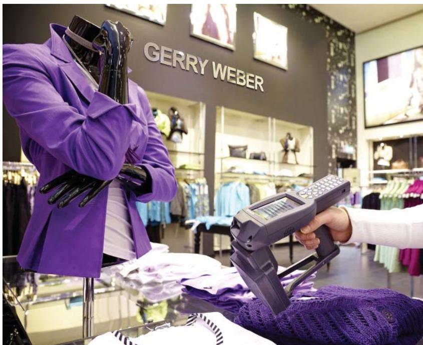
(EPC) bereits bei der Herstellung „verheiratet“ und in einer zentralen Datenbank gespeichert. Diese ist über einen RFID-Konnektor an das von Gerry Weber eingesetzte Warenwirtschaftssystem alexa gekoppelt. Die mittels EPC identifizierte Ware durchläuft, gesteuert vom Modul alexa RFID, alle Filialprozesse, bis sie an der Kasse final aus dem EPC-Warenbestand gelöscht wird. Der Kunde verlässt das Geschäft, ohne dass die Deckensicherungsantennen
