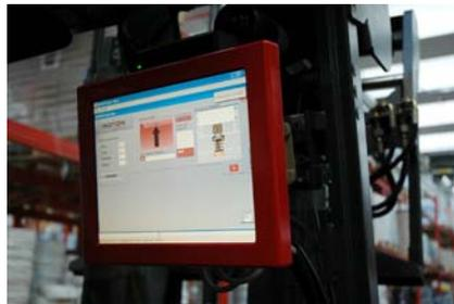
verbunden. Außerdem erhält das Hubgerüst Sensoren für Hubhöhe und Beladungszustand der Gabel. Beim Überfahren eines Tags liest der Stapler dessen Positions-ID. Zusammen mit der aktuellen Höhenangabe wird daraus die Identität des Lagerplatzes ermittelt. Meldet der Beladungssensor das Be- oder Entladen der Gabel, werden die Daten per WLAN an das Lagerverwaltungssystem weitergegeben. So wird über die Lagerplatzerkennung die Ware identifiziert.
