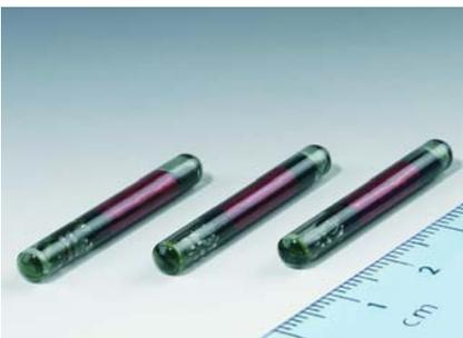
Diese Probleme werden umgangen, indem man das Prinzip umkehrt: Statt die Ware mit beweglichen Sendern zu bestücken, wird das Lager mit stationären, passiven RFID-Transpondern ausgerüstet. Die etwa streichholzgroßen Bauteile werden nur dort, wo Daten erfasst werden müssen, im Boden eingelassen. Das sind vor allem Lagerplätze, Übergabepunkte und Verladebereiche.
