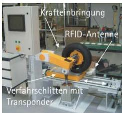
Am Institut stehen unterschiedliche Prüf- einrichtungen zur mechanischen Prüfung von Transpondern zur Verfügung. Auf einem Hydropulser können zeitlich veränderliche Kraftprofile mit einer Amplitude von bis zu
