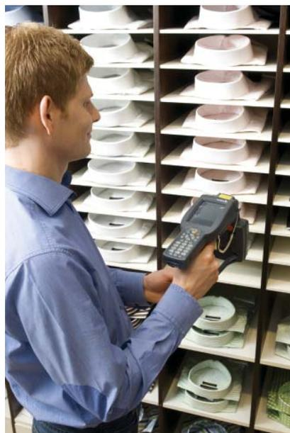
Abb.: Bestände können mit einem mobilen RFID-Reader direkt am Regal erfasst werden.
