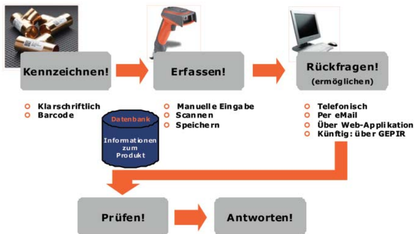
Abb. 3: Fälschungssicherheit durch Serialisierung – das Konzept
