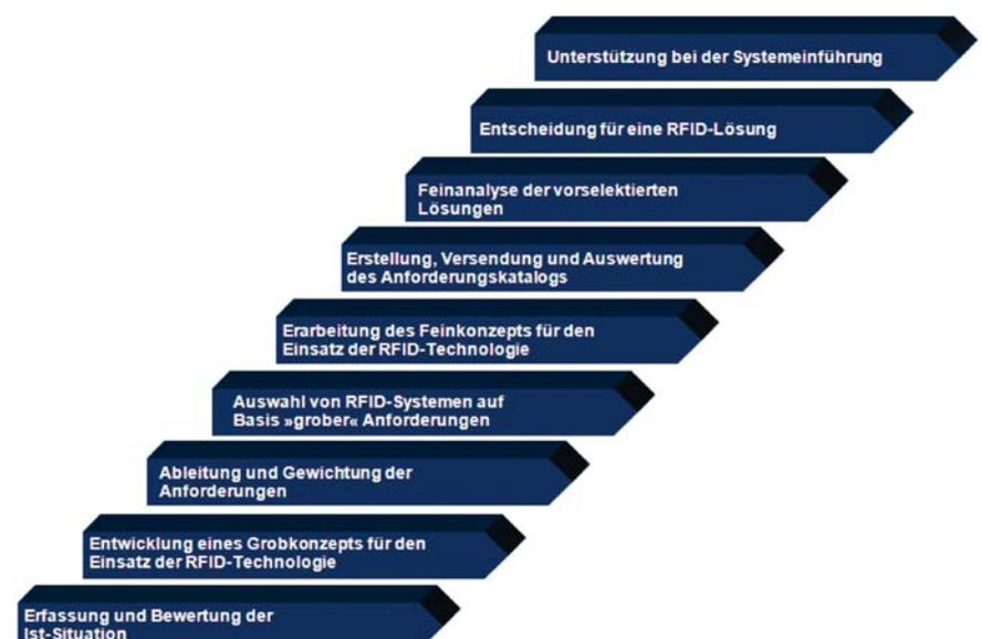
Abbildung 2: Stufenkonzept zur Konzeption, Auswahl und Implementierung einer RFID-Lösung
