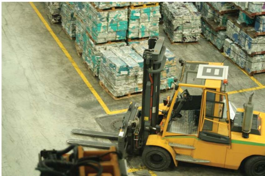
Abbildung 2: Betriebsmittel mit optischem Marker zur Ortung in der Intra-logistik – Foto: Martin Kirch, Fraunhofer IFF
