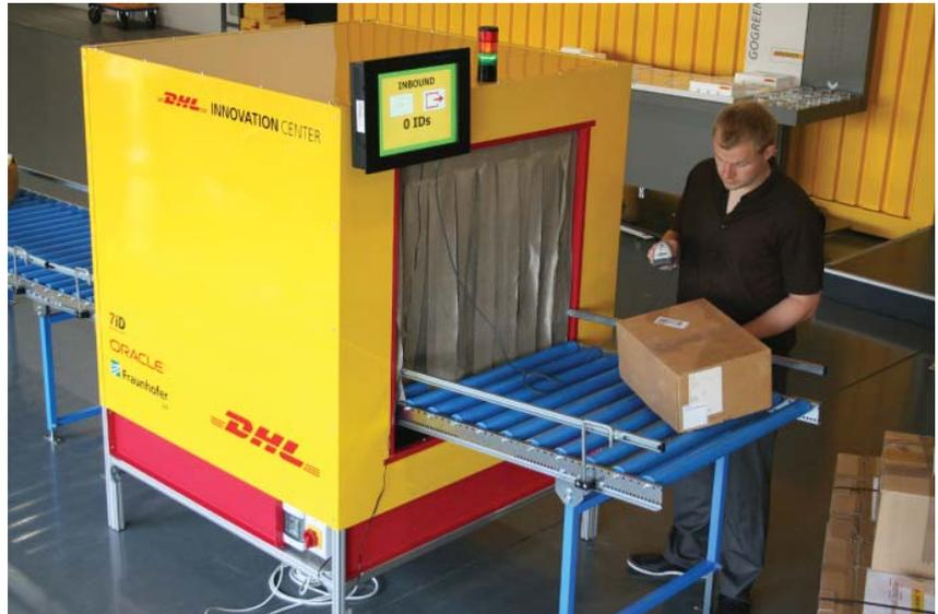
Abbildung 1: RFID-Tunnelgate zur vollständigen Inventarisierung der in Kartons verpackten Kleidungsstücke – Foto: Martin Kirch, Fraunhofer IFF
