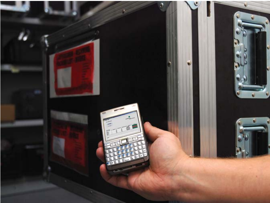
Abb. 2: Auslesevorgang des Ersatzteilbehälters mit einem mobilen Endgerät
