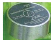
**Abbildung 10: RFID-Transponder mit Sensorik und Batterie für die Log-Funktion**
