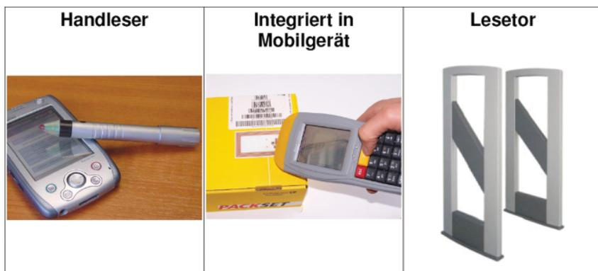
Abbildung 3: Auswahl RFID-Leser und Antennentypen, als Pen, mobil und stationär als Gate.
