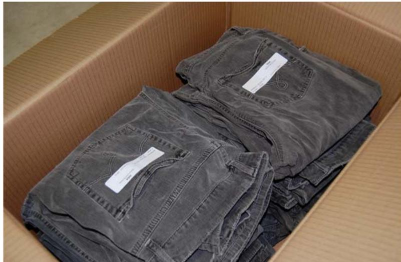
Abbildung 1: Bekleidungsstücke mit selbstklebenden RFID Papiertranspondern
