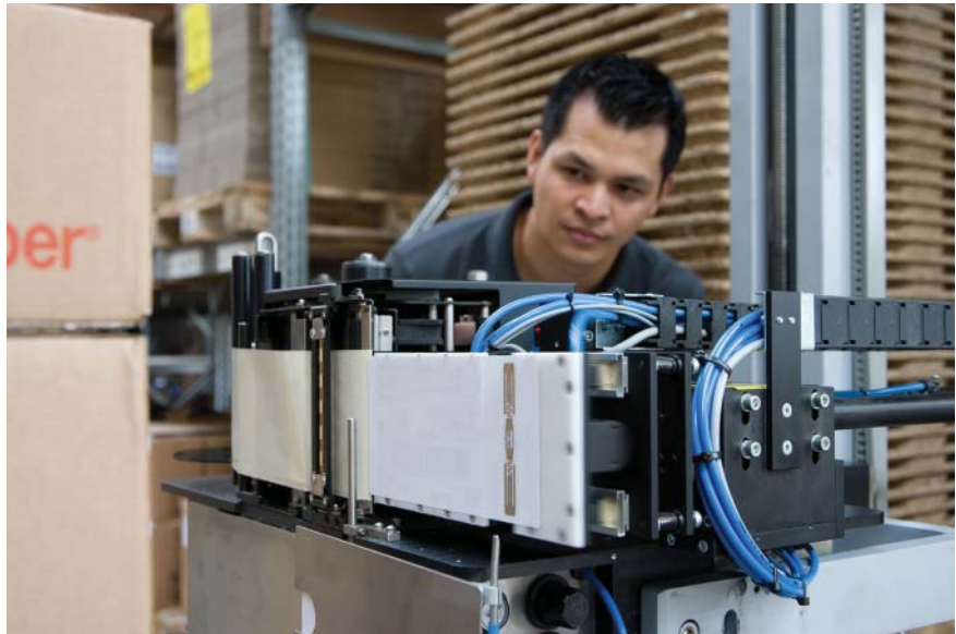
Sogenannte „Print, Code & Apply“-Systeme beschreiben und bedrucken RFID-Etiketten und spenden diese vollautomatisch auf.
