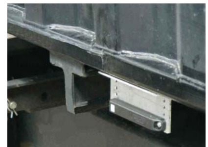
RFID-Transponder an der Wechselbrücke
