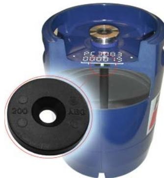
Eine Möglichkeit bei der RFID-basierten Identifikation von Fässern ist die Integration des Transponders bereits bei der Keg-Herstellung
